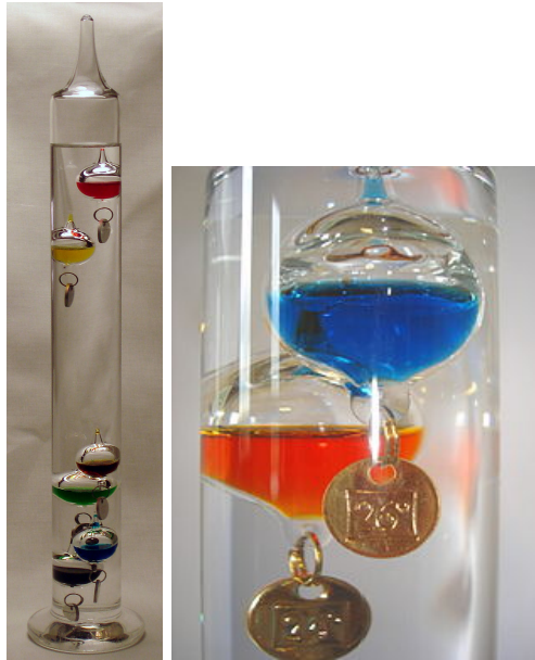
FIGURE 1 – Le thermomètre de de Galilée (1602). [?, Wikipédia]
